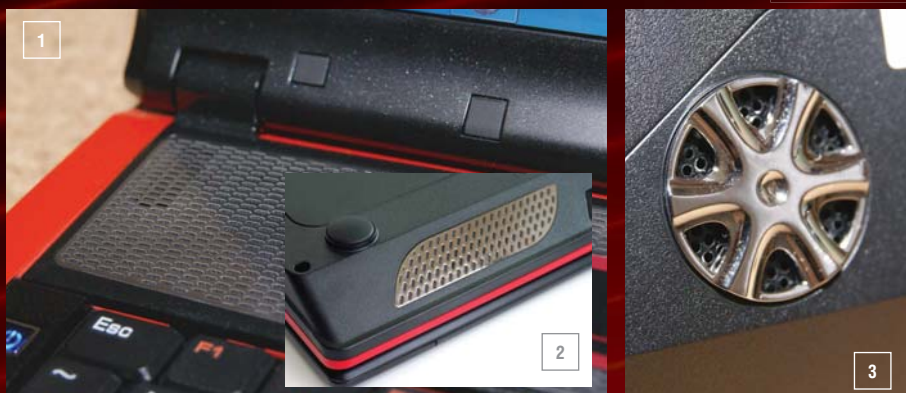
Встроенная акустика для объемного звучания: 1 – фронтальная, 2 – боковая, 3 – сабвуфер
