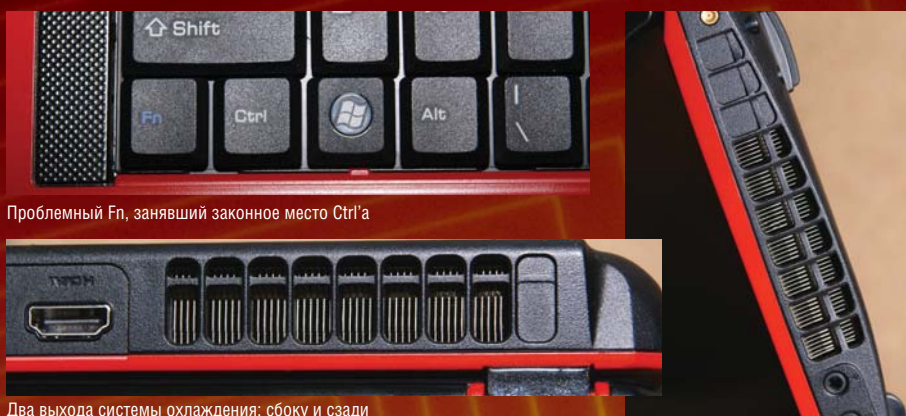
Два выхода системы охлаждения: сбоку и сзади
