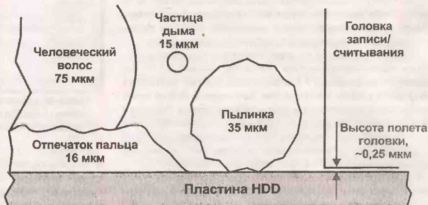
Сравнительные размеры миниатюрных частиц и высоты полета головки над поверхностью винчестера — даже незаметная вооруженным глазом пылинка может стать серьезным препятствием
