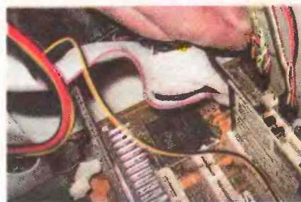
Рис. 4.9. Подключение индикаторов передней панели
