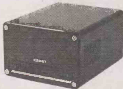
Корпус накопителя QNAP TS-219 Turbo NAS выполнен в основном из металла, и лишь лицевая глянцевая панель пластиковая
