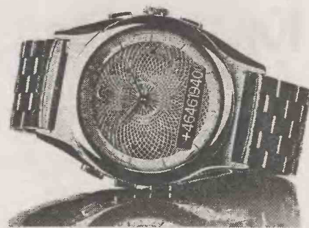
Часы, которые сообщают о входящем вызове посредством вибрации, а также показывают имя звонящего или его номер: Sony Ericsson Bluetooth-Watch MBW-200
