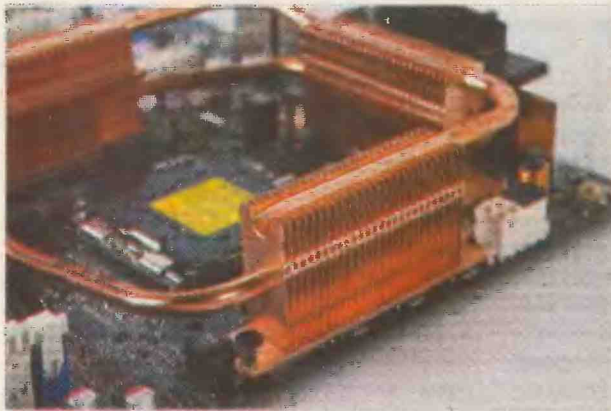
Важные элементы Asus 680I Striker Extreme охлаждаются медными радиаторами с тепловыми трубками. Ближайший накрывает мосфеты (видны ножки)
