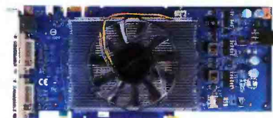
Рис. 1 Albatron GeForce 9600GT оборудован оригинальным кулером
