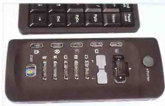
Рис. 7 На правой стороне LuxeMate 810 расположен набор кнопок для управления медиацентром
