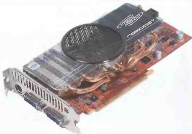
Уникальная СО на MSI N9600GT Hybrid Freezer повысила цену видеокарты, но не обеспечила достойного прироста производительности
