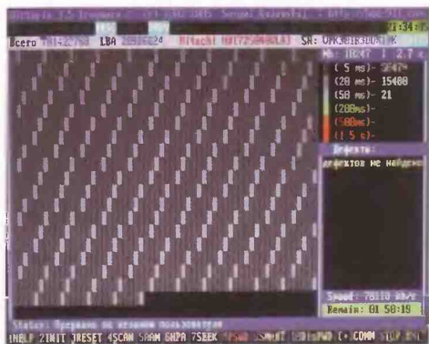
Рис. 10 Задержек на 20 мс у Т7К500 очень уж много. Высокой скорости от этого винчестера уже не ждем
