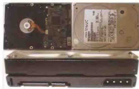
Рис. 9 Все, кто имел дело с винтами Hitachi, знают, что отверстие барометра на верхней крышке закрывать нельзя. Т7К500 — не исключение
