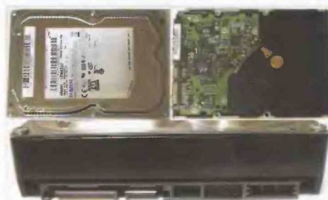
Рис. 5 Только по надписям на наклейке можно определить, что перед нами HD642JJ на 640 Гб, а не терабайтник из той же серии
