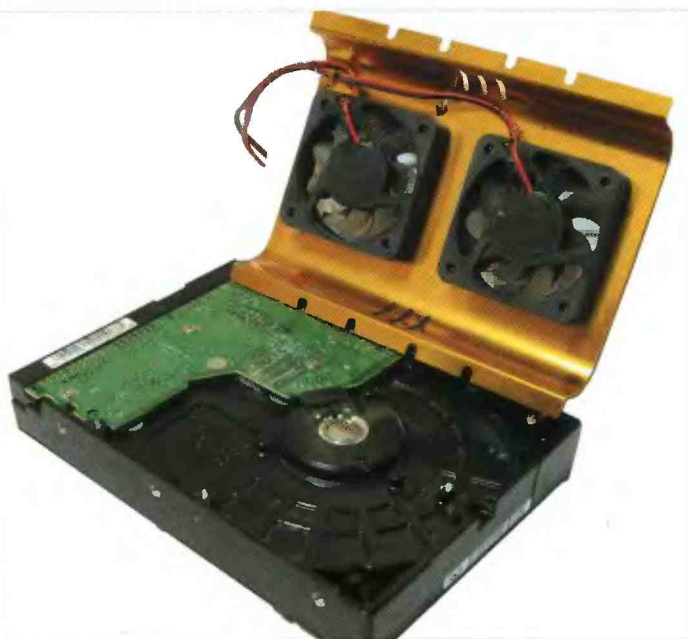
Рис. 1 Такая простейшая система охлаждения для HDD уже достаточно эффективна, однако она не лишена серьезных недостатков
