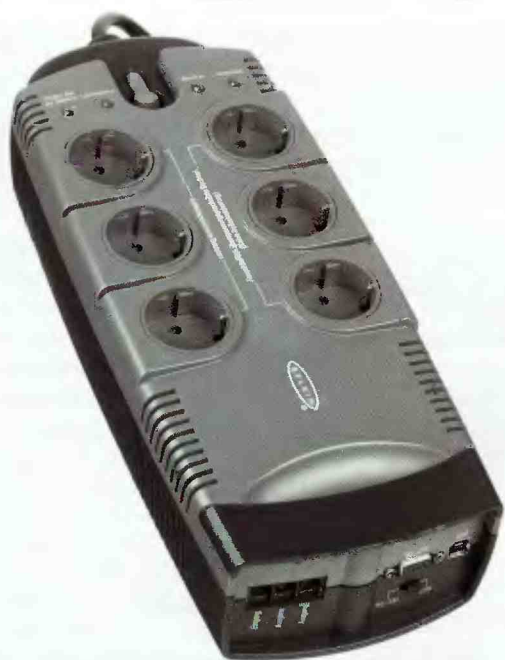
ИБП могут выглядеть и таким образом. Батарея вмещается небольшая, но зато устройство получается очень удобным
