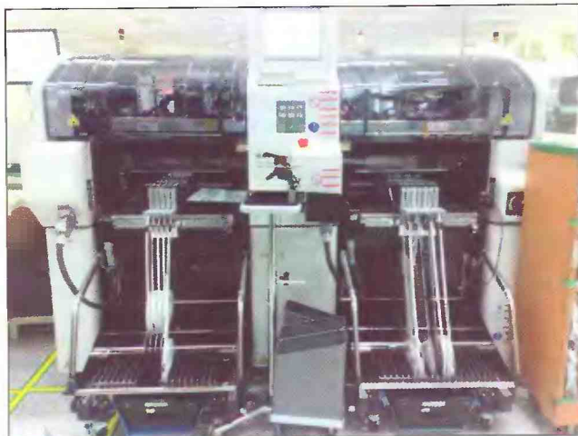
За монтаж микросхем оптических элементов и других компонентов отвечает оборудование на полностью автоматизированных конвейерах
