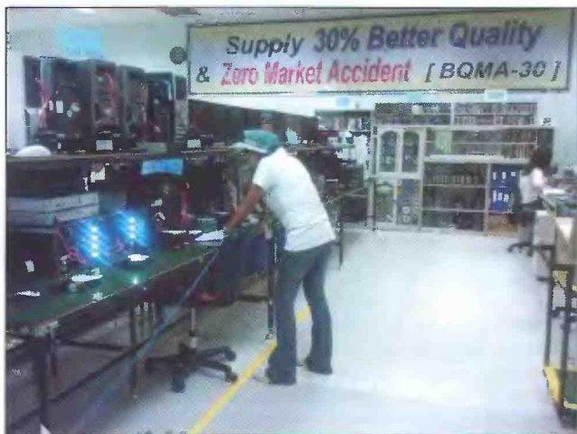
Специальное подразделение исследовательского центра завода SEPHIL обязательно занимается проверкой совместимости готовых приводов с рядом ноутбуков и десктопов
