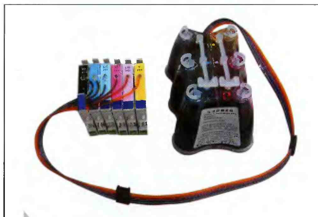
СНПЧ (система непрерывной подачи чернил) способна заметно удешевить стоимость отпечатков, полученных на струйнике
