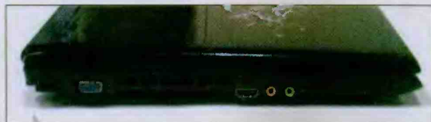
Слева лучше всего видно сопло системы охлаждения
