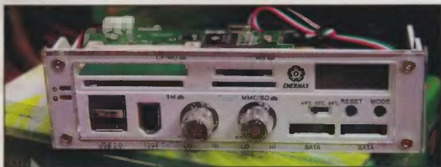
Рис.7 О как — SATA на передней панели компьютера!
