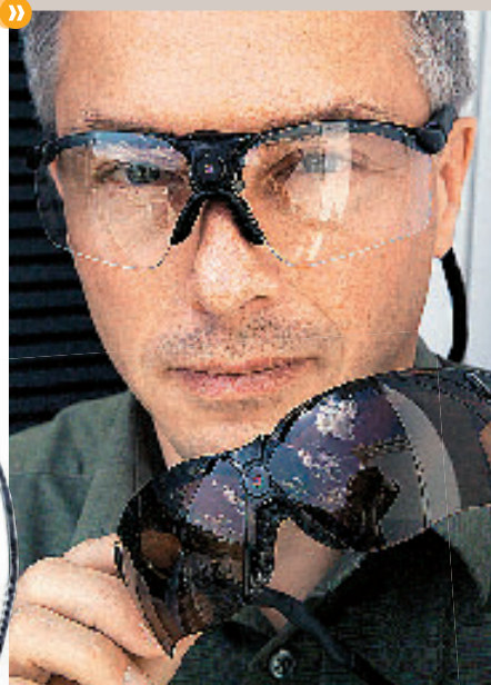
Комплект для ведения непрерывной видеосъемки включает камеру, прикрепленную к солнцезащитным очкам, и блок хранения
