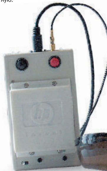
Комплект для ведения непрерывной видеосъемки включает камеру, прикрепленную к солнцезащитным очкам, и блок хранения
